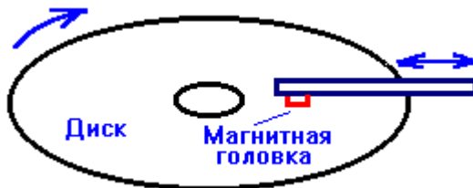
Схема работы памяти на магнитном диске
